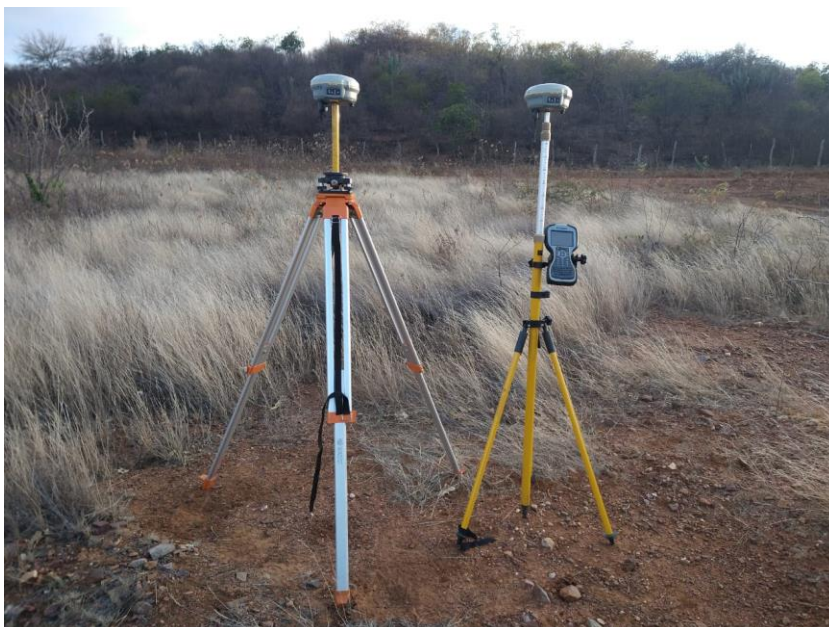
Figura 2: Equipamento utilizado para levantamento planialtimétrico Fonte: Autor
